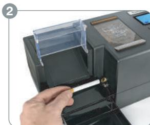
Stecken Sie eine Hülse über der Injektionsöffnung und drücken Sie START.
