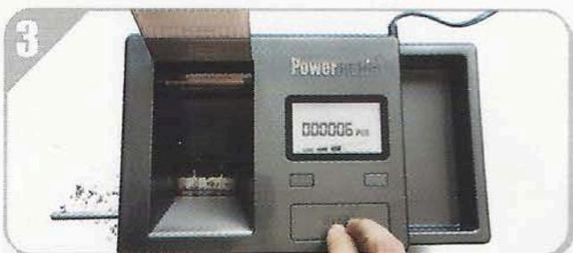
Den Deckel des Tabakschachts wieder öffnen, um den Füllstab wieder einzufahren. START drücken, um eventuell noch vorhandene Tabakrückstände durch die Bewegung zu entfernen.
