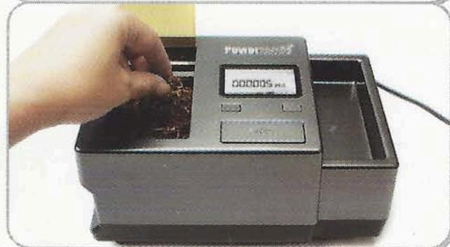
Wenn HOPPER auf der Anzeige erscheint, den Deckel des Tabakschachts öffnen und Tabak zufügen oder den vorhandenen Tabak lockern.
