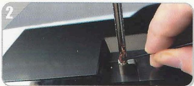
Den Deckel des Tabakschachts schließen und mit dem Reinigungsstab alle Tabakreste vom Füllstab abkratzen, auch auf der Rückseite. Der Füllstab muß komplett frei von Tabakresten sein.
